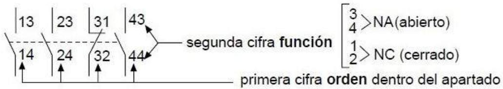
El número propio del contactor **identifica el número de contactos que tiene normalmente abiertos o normalmente cerrados**, de la forma siguiente:
